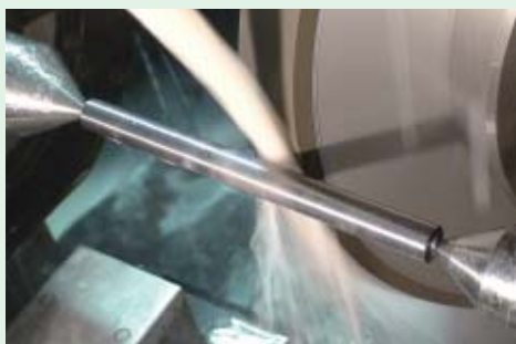
写真2/figure2 円筒研削盤によるセンター作業 Centering for cylindrical grinding machine
