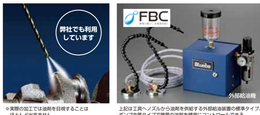
※実際の加工では油剤を目標することはほとんど出来ません。上記は工具へノズルから油剤を供給する外部給油装置の標準タイプ。ポンプ内蔵タイプで微量の油剤を精密にコントロールできる。
