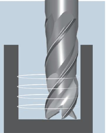
工具径の  $\phi dx125\% \sim \text{MAX}2$  倍まで可能
